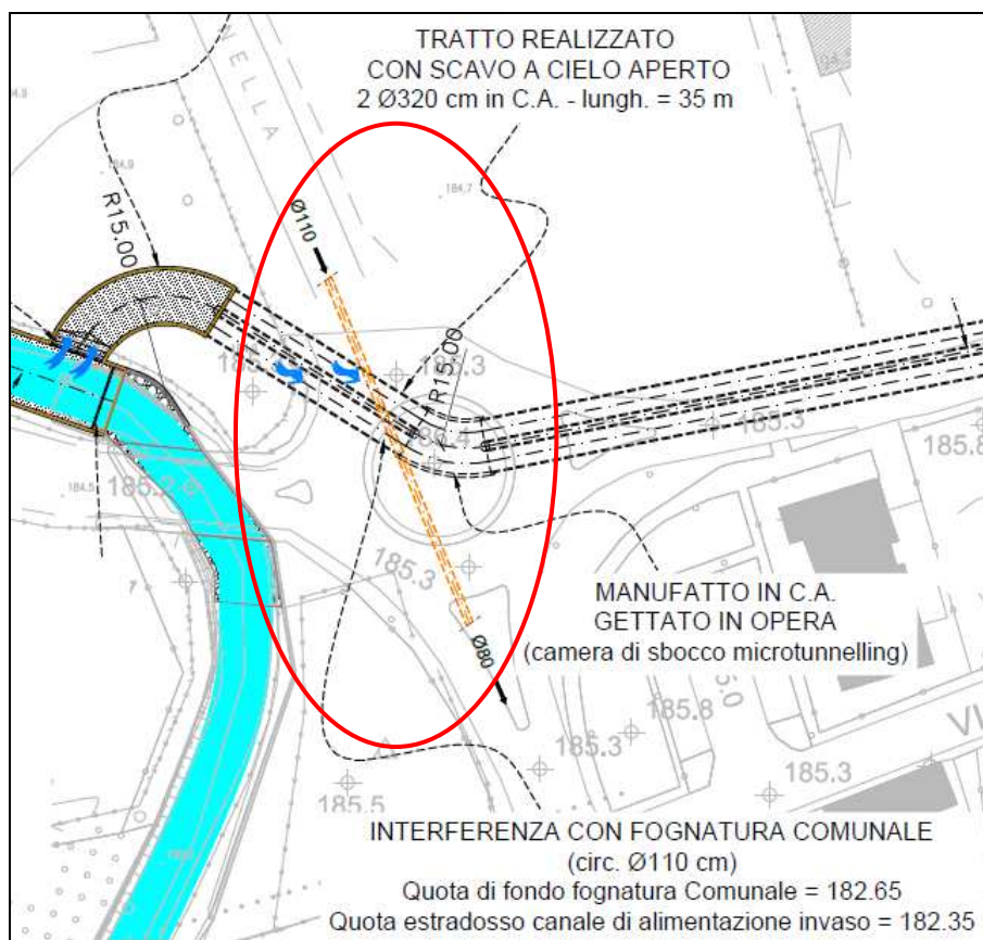
Figura 22 – Stralcio della planimetria delle condotte di alimentazione della vasca di Varedo con indicazione dell'interferenza con la rete fognaria comunale
